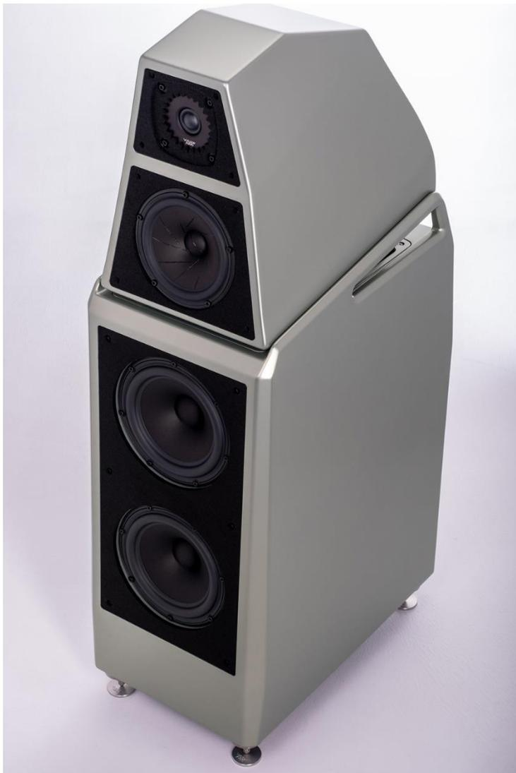
Sasha V 採用雙 8 吋低音，箱體主要使用 X-Material 製作，而且厚度比 Sasha DAW 增加了 25%，這也是 Sasha V 尺寸變大的主要原因，X-Material 的厚度明顯增加，但不能減少箱體容積，所以喇叭尺寸要跟著變大，而 Sasha V 低音箱體的頂板，則使用 V-Material，強化其隔離與阻尼效果。
